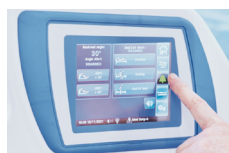
Alarmy: 3-stopniowy wyjścia z łóżka* oraz obniżenia segmentu oparcia poniżej 30°/45°
